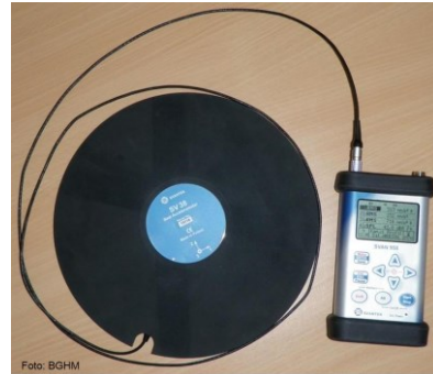
Beschleunigungsaufnehmer für Messungen auf dem Sitz
