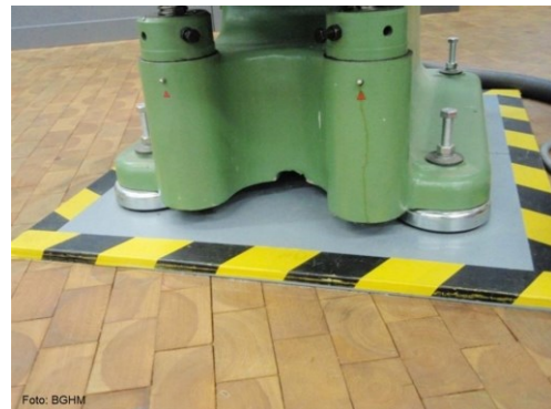
Aufstellung einer Maschine mit Schwingungsisolatoren
