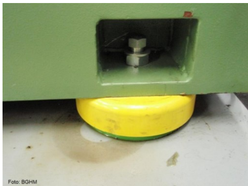
Aufstellung einer Maschine mit Schwingungsisolatoren
