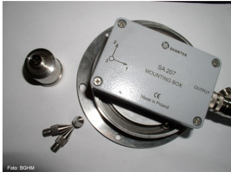
Beschleunigungsaufnehmer für Messungen auf dem Boden
